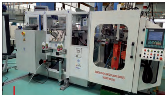
L'IML Center dispose à demeure d'une machine d'extrusion-soufflage équipée pour des essais et démonstrations.
