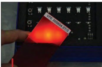
Une expertise Treffert : diffusion ou masquage de la lumière par des additifs.
