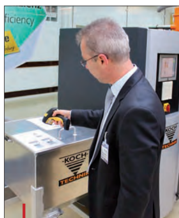
Avant envoi vers le sécheur, la conformité de la matière était confirmée par la lecture d'un code-barres.
