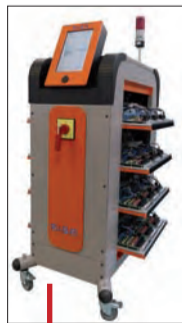
L'accès aux cartes puissance du régulateur MV3 est facile.
