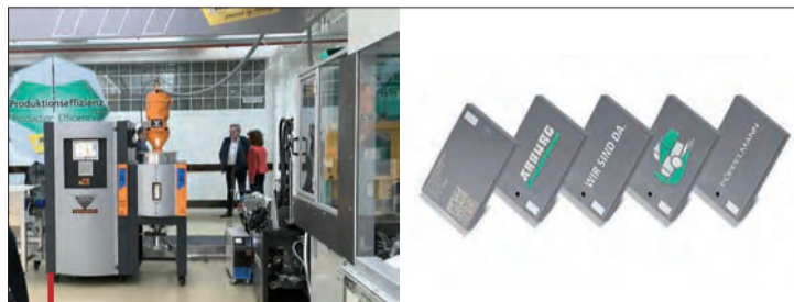
Ce sécheur Koch EKO 200 alimentait la presse Arburg injectant des étiquettes en PP sur lesquelles était ensuite fixée une puce NFC.
