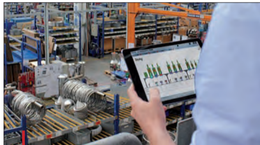
Chaque fonction périphérique, séchage, dosage, alimentation, etc, dispose de son propre écran de paramétrage et gestion.
