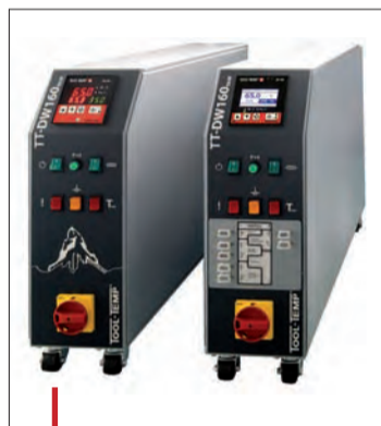
Compact et puissant, le régulateur à eau TT-DW160 peut travailler jusqu'à 160°C.
