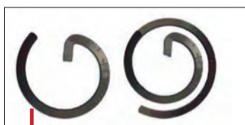
RocTool améliore de 100 % la longueur d'écoulement de cette pièce spiralee de 1,5 mm d'épaisseur moulée en PEI.
