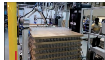
Le Half-Cube Palletizer, une nouvelle application de la robotique collaborative.
