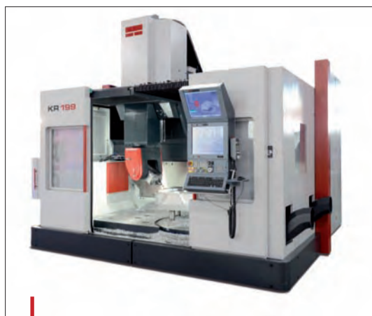
Fraiseuse 6 axes KR199 équipée d'une tête birotative continue et d'une table rotative de 1200 mm de diamètre.
