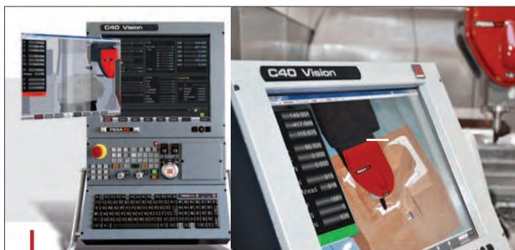
C.n. Fidia C40 Vision intégrant le contrôle de collision ViMill capable de travailler en 5 axes.
